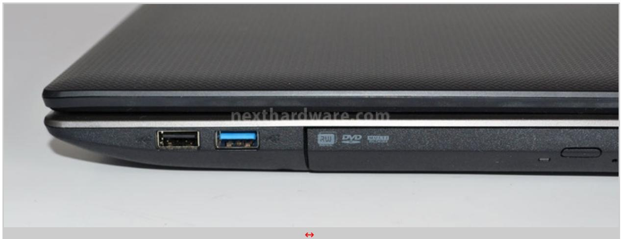
Sul lato destro, sono installate altre due porte USB 2.0; il modello testato è dotato anche di una porta USB 3.0 in sostituzione di una delle due 2.0, ma i modelli destinati al mercato italiano non saranno dotati della nuova interfaccia di comunicazione.
