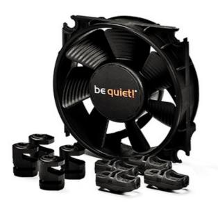
caratteristiche di silenziosità uniche ed elementi di fissaggio intercambiabili. Le ventole della linea SilentWings 2 utilizzano l' oramai collaudata tecnologia Fluid Dynamic Bearing (FDB) che prevede un cuscinetto galleggiante in un particolare fluido, per ridurre ai minimi termini gli attriti e, di conseguenza, il rumore generato.
