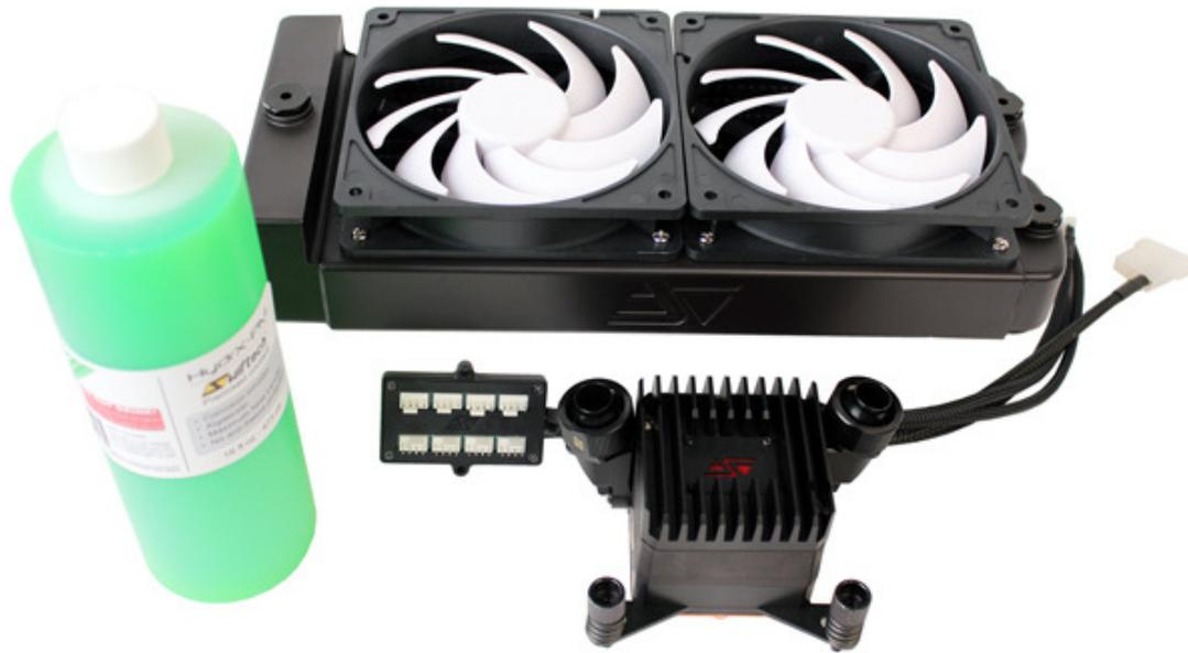
Il kit comprende inoltre due o tre ventole Helix PWM da 120mm, uno splitter PWM a 8 vie, i raccordi a compressione, la tubazione necessaria ed una bottiglia da 500ml di liquido di raffreddamento Swiftech Hydrex.
