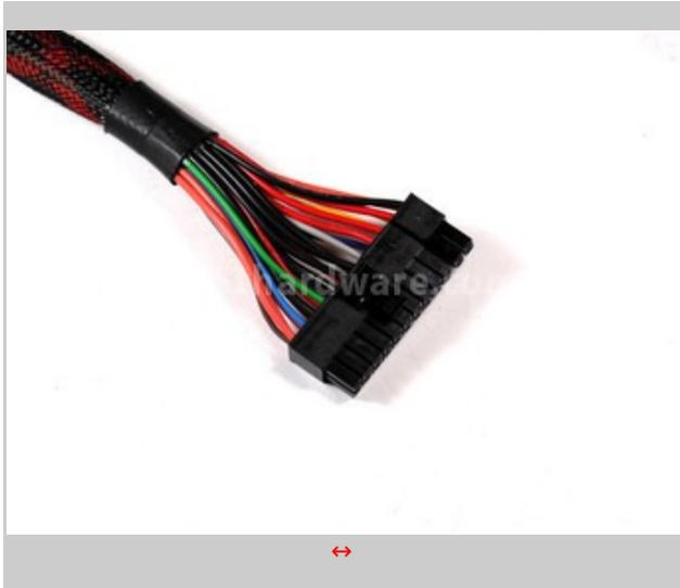
Cavo di alimentazione ATX 20+4 Pin
