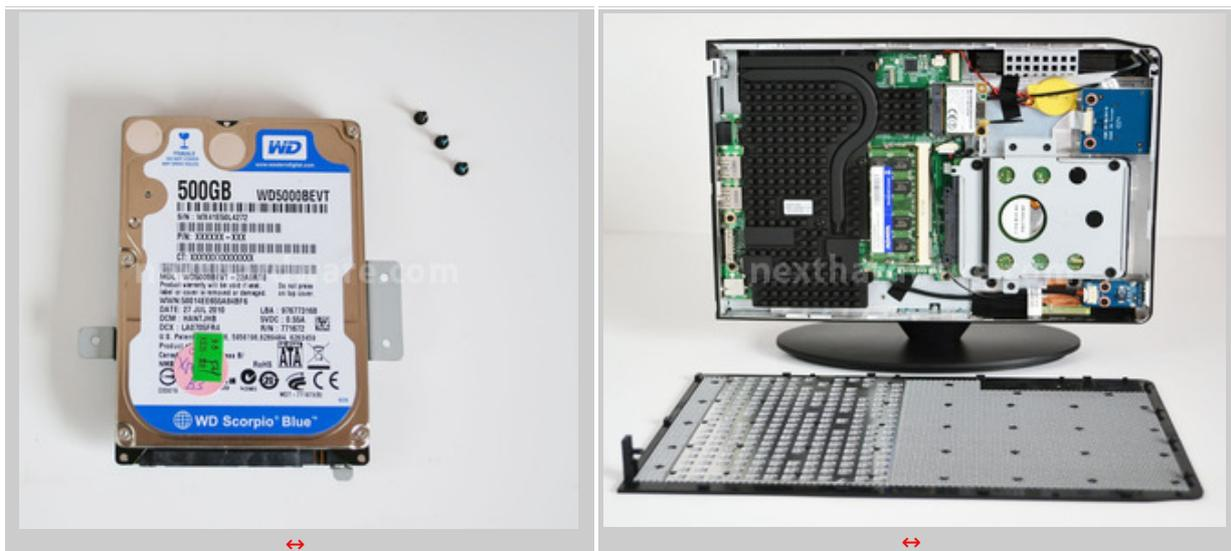
L'Hard Disk è di produzione Western Digital, appartenente alla serie Scorpio Blue, caratterizzato dalla velocità di rotazione di 5.400 rpm, 500 GB di spazio, interfaccia SATA 3Gb/s e 8MB di cache.
