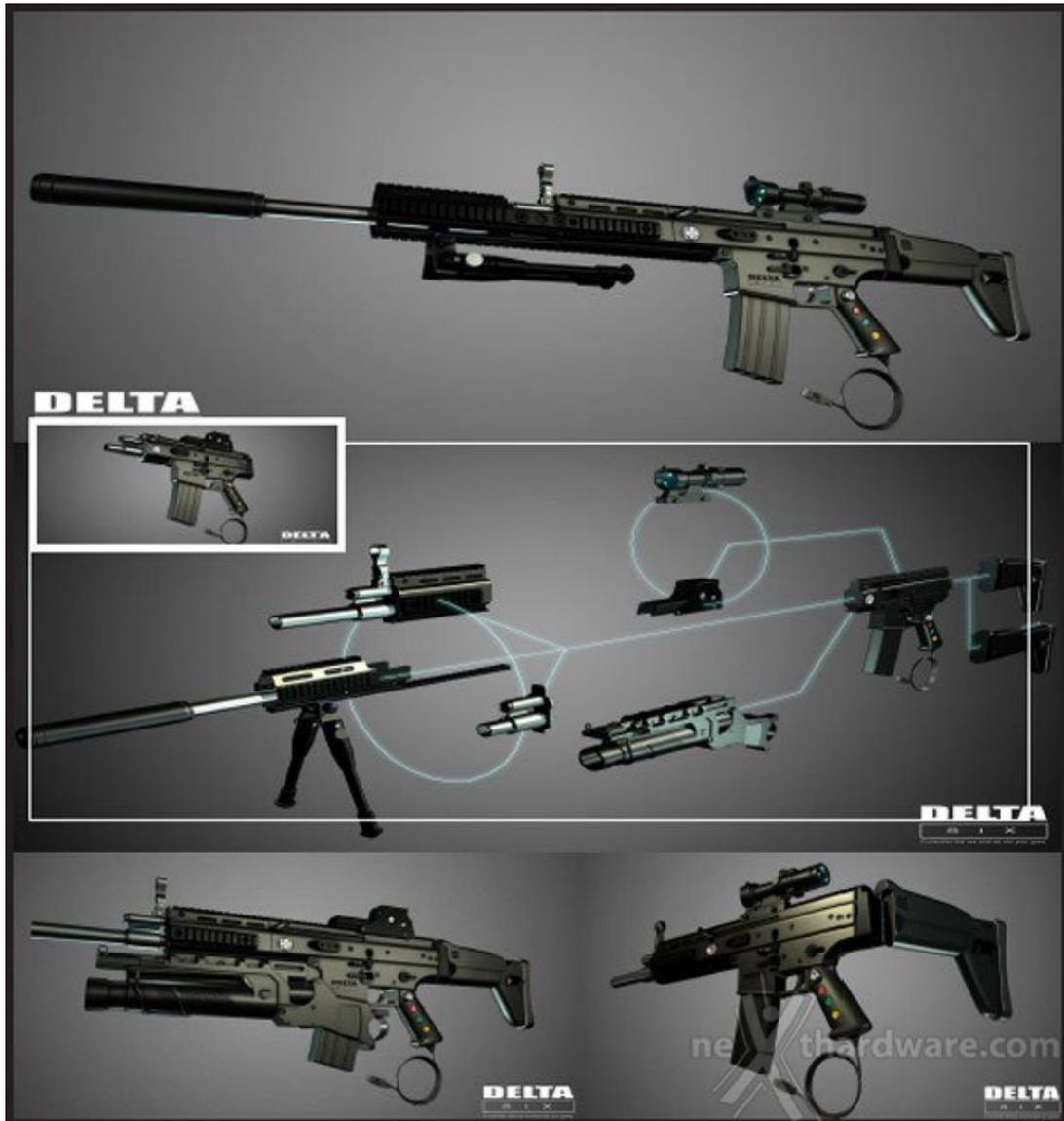
Il controller fa uso di accelerometri per gestire i movimenti, non richiedendo, quindi, una calibrazione iniziale per poter funzionare, è dotato di alcuni pulsanti sull'impugnatura dell'arma e la ricarica può essere eseguita sostituendo fisicamente il caricatore dell'arma, simulando al meglio le reali condizioni di combattimento.
