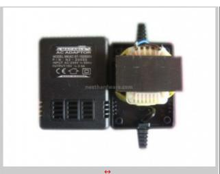
L' alimentatore Maccable fornisce 15v a 2.5A.
