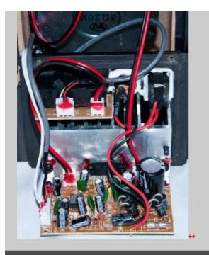
In un sistema totalmente integrato, l'adozione di un chip di amplificazione in classe D permette la riduzione degli ingombri e del consumo energetico, avendo come risultato anche un minor calore da dissipare.
