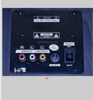
Nella parte posteriore del diffusore, troviamo, oltre al tubo di accordo reflex, un pannello di metallo che ospita le connessioni delle Neso2 NS2-20050.
