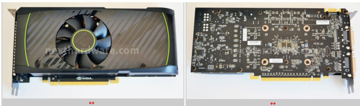
La cover del dissipatore di calore è sagomata in modo da convogliare l'aria all'esterno del case e può essere completamente rimossa per effettuare le operazioni di pulizia, senza dover smontare il sistema di raffreddamento dal PCB della scheda.
