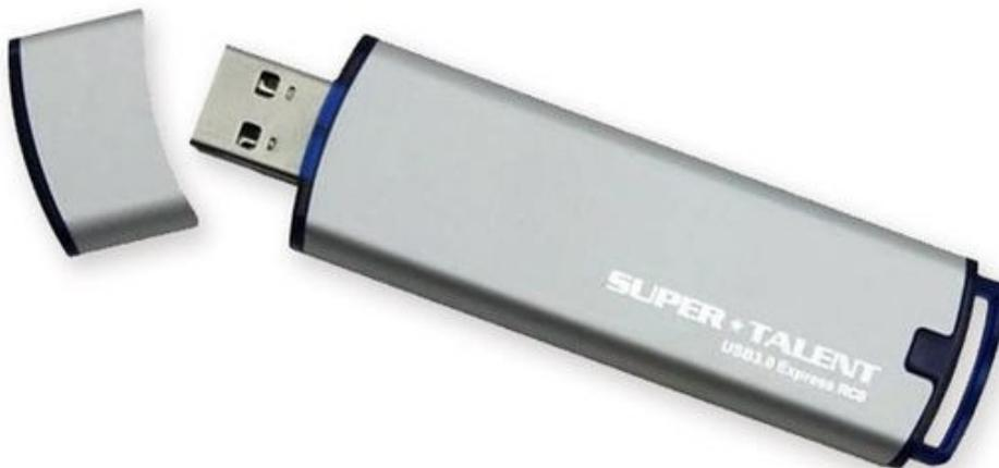
La Super Talent RC8 si candida come una delle pendrive USB 3.0 più veloci sul mercato, essendo equipaggiata con un controller SandForce SF-1122 a 8 canali e capace di una velocità di trasferimento pari a 270MB/s in lettura e 240MB/s in scrittura.
