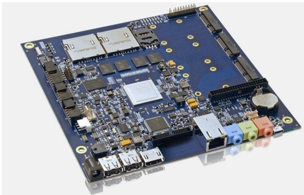
Kontron sta per lanciare la KTT30, la prima scheda integrata equipaggiata dal SoC Nvidia Tegra 3, soluzione ideale per realizzare Mini-PC a basso consumo e con un ingombro minimo, ma con le elevate performance multimediali offerte dal chipset Nvidia.
