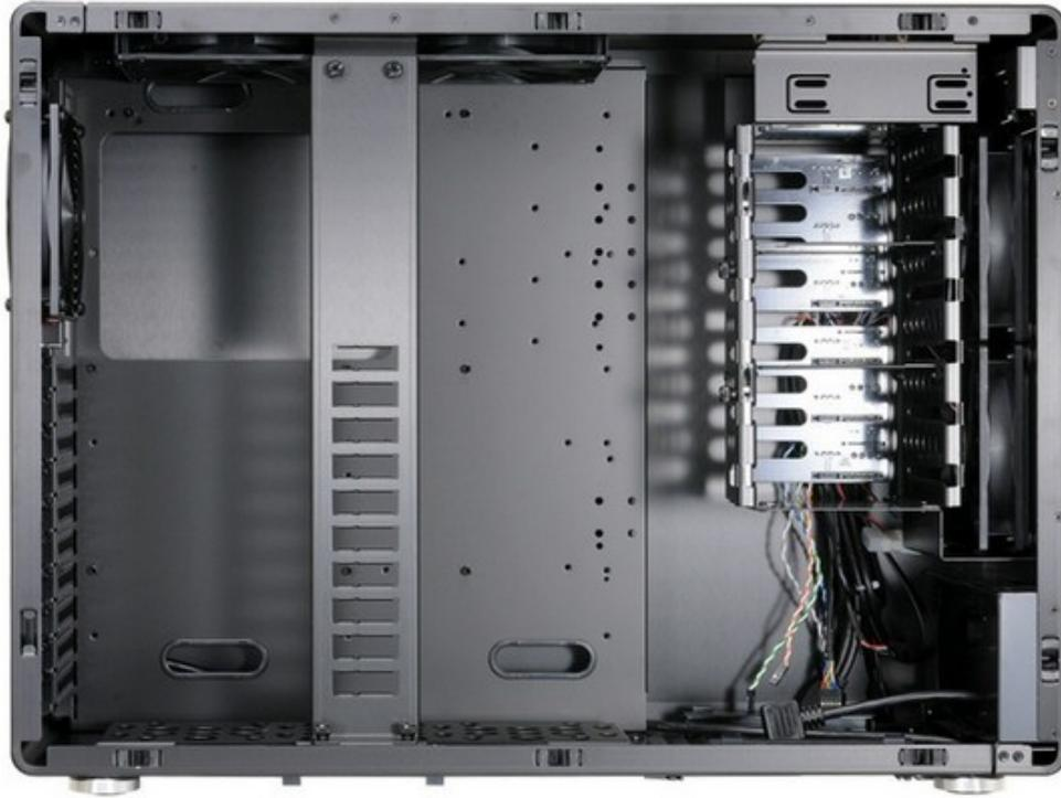
Il case misura 440 millimetri (17,32 ") in altezza e può contenere fino a sei hard disk da 3,5" con funzionalità Hotswap ed un HDD da 2,5" nella parte inferiore dello stesso supporto; ulteriori due drive da 2.5" possono essere installati rinunciando ad altrettante unità da 3,5".
