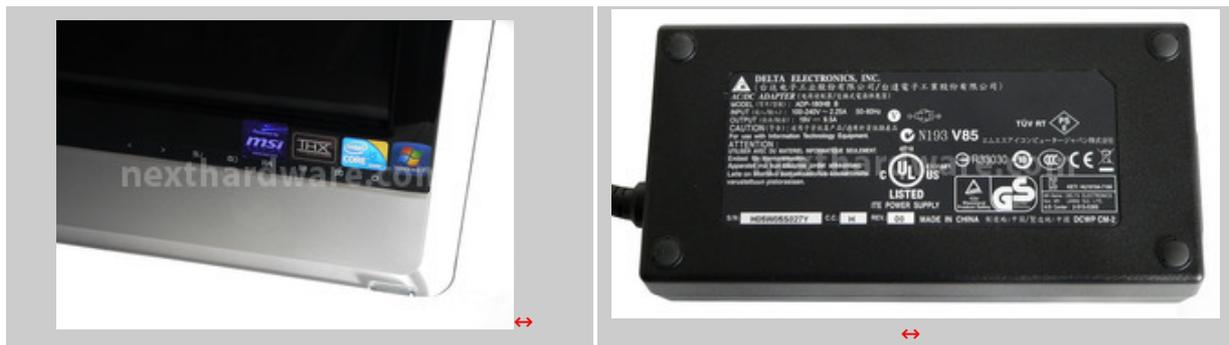
Il sistema è alimentato da un alimentatore esterno da 180W, potenza contenuta se paragonata a quella dei moderni sistemi desktop, ma più che sufficiente per gestire il processore Intel Core i5 650 e la scheda video ATI Mobility Radeon HD 5730 utilizzati in questo AIO.
