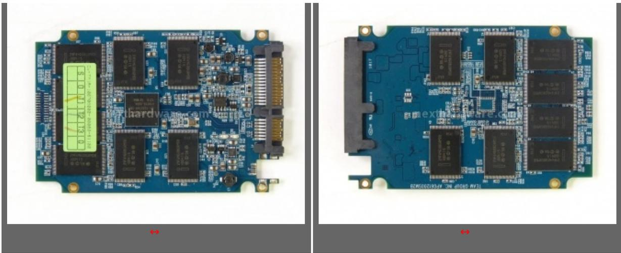
Layout particolare delle unità dotate di controller SandForce, diverso rispetto agli SSD di precedente generazione. Possiamo vedere, dalle immagini di cui sopra, il controller che è posizionato al centro del PCB con i chip NAND disposti attorno ad esso. La versione da 120 GB dispone di un'ulteriore serie di chip di memoria nella parte inferiore.
