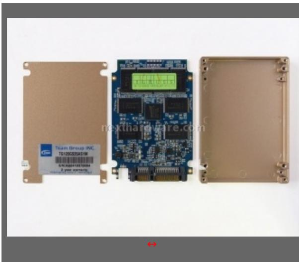
L'insieme degli elementi che compongono la struttura dell'SSD: il guscio inferiore di contenimento, il PCB con l'elettronica di controllo ed il coperchio superiore.
