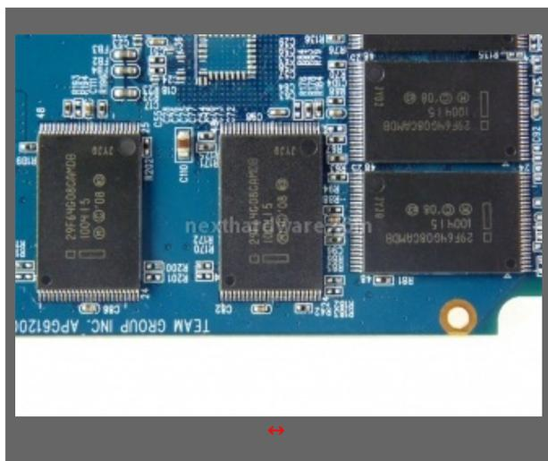
I chip NAND 2Bit Multi Level Cell di seconda generazione sono prodotti da [IM Flash technologies](http://www.imftech.com/) con tecnologia 34nm e una densità pari a 8GByte per chip con specifica ONFI 2.0.
