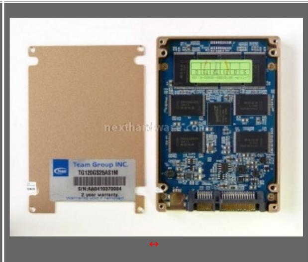
Dopo aver rimosso le 4 viti che assicurano il fondo dell'SSD alla struttura e dopo aver tagliato il sigillo di garanzia, abbiamo accesso al PCB. Quest'ultimo è a sua volta fissato alla parte superiore dello stesso tramite altre 4 viti.
