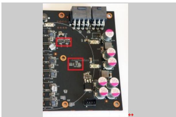
In evidenza i tre chip di controllo che si occupano di monitorare i consumi delle tre linee di alimentazione della scheda (PCI-E 8 pin, 6 pin e connessione PCI-E 16x).
