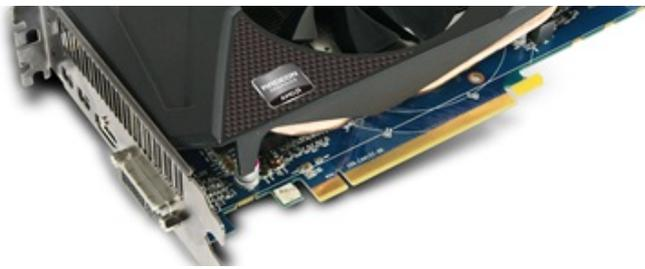
SAPHIRE presenta, già al lancio, due distinti modelli di HD 7770, ovvero la HD 7770 GHz Edition con frequenza di clock pari a 1GHz per la GPU e a 1125 MHz per le memorie, e la HD 7770 GHz OC Edition con overclock di fabbrica per la GPU a 1150 MHz e per le memorie a 1250 MHz.
