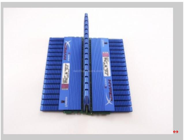
I tre moduli appaiono molto solidi, i dissipatori sono ad alto profilo e sono realizzati in alluminio verniciato blu, consentendo di smaltire il calore in maniera molto efficiente. Da notare che non sono presenti viti per il serraggio, ciò significa che i dissipatori sono fissati agli IC dei moduli ram per mezzo di un pad termico adesivo.
