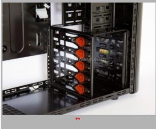
Le due foto in alto ci mostrano il cestello per il montaggio degli hard disk in grado di accogliere cinque periferiche. Il sistema di fissaggio tool free è identico nel funzionamento rispetto a quello visto per le periferiche da 5,25â€. In questo caso le periferiche, una volta montate, risultano abbastanza stabili all'interno della loro sede.
