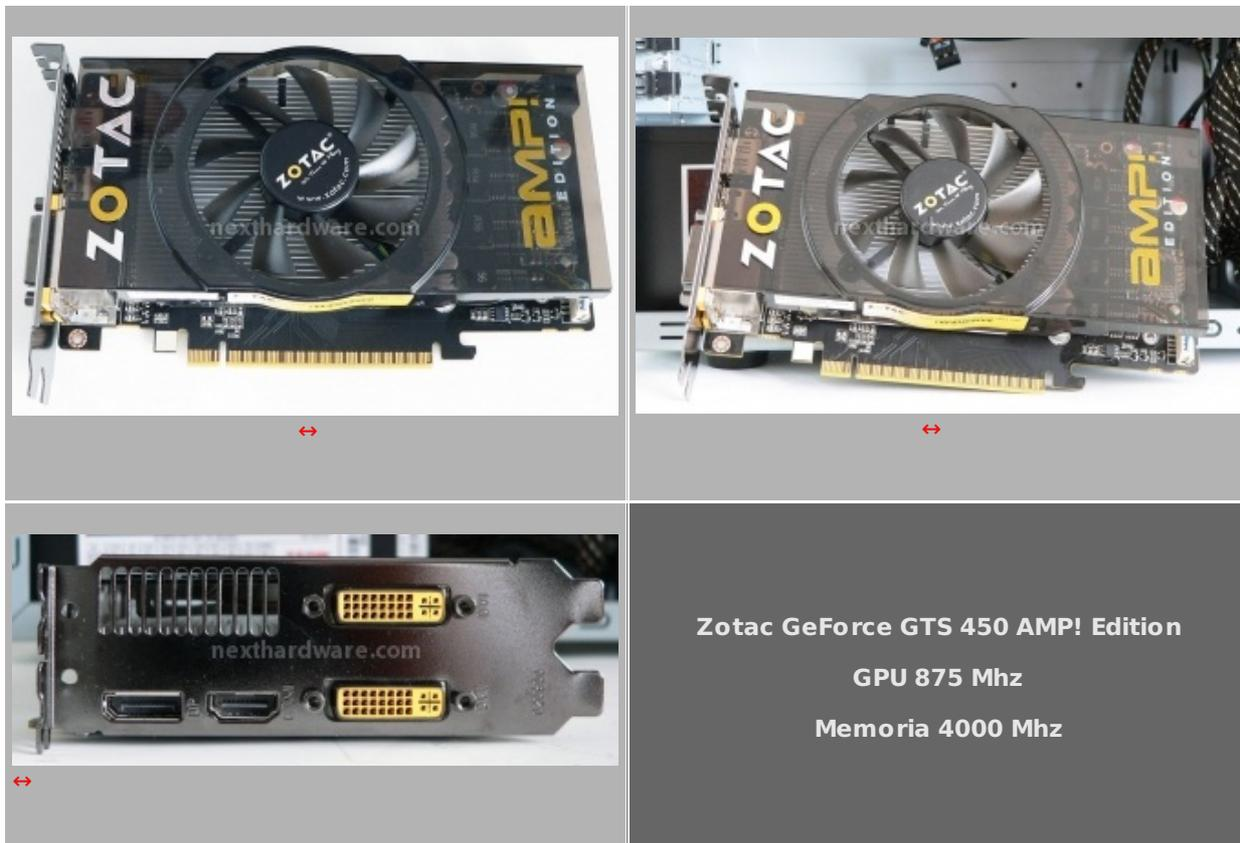
Il sistema di raffreddamento della Zotac GeForce GTS 450 AMP! è caratterizzato da una singola ventola centrale piuttosto silenziosa e da un dissipatore in alluminio coperto da una cover plastica trasparente. La scheda richiede di essere alimentata con un cavo PCI-E 6 pin posto sul retro della stessa, il TDP (Thermal Design Power) dichiarato è infatti di 106W, una potenza non erogabile dal solo slot PCI-E 16x.
