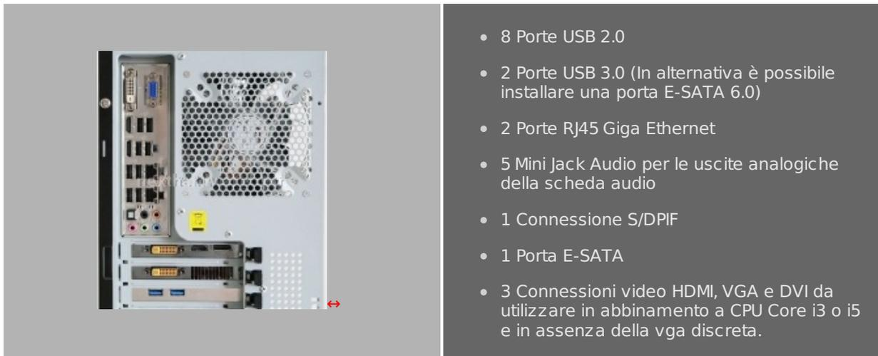
La scheda video in dotazione, mette a disposizione 2 uscite DVI Dual Link, 1 porta HDMI e 1 Display Port; ricordiamo che solo due di queste interfacce possono essere usate in contemporanea.
