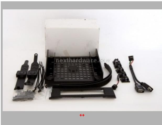
Il bundle in dotazione al Colossus prevede: la viteria, alcuni passacavo dotati di adesivi, due robuste fascette in plastica per raccogliere i cavi più grossi, alcune fascette piccole, l'adattatore ed il frontalino per installare le periferiche da 3,5€ sul frontale.
