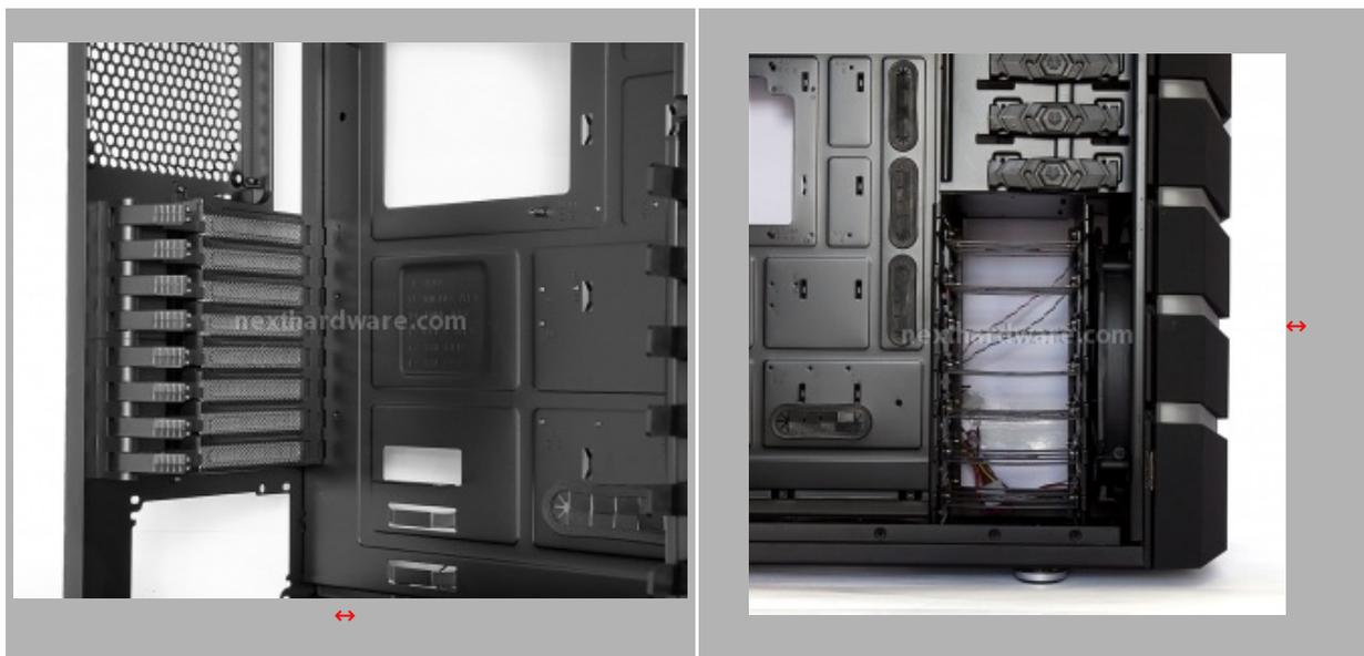
Le foto di cui sopra, ci mostrano il sistema di fissaggio delle schede di espansione ed il cestello per il montaggio delle periferiche da 3,5€, entrambi rigorosamente tool free. Il primo, in particolare, ci ha colpiti per la notevole robustezza ed efficienza.
