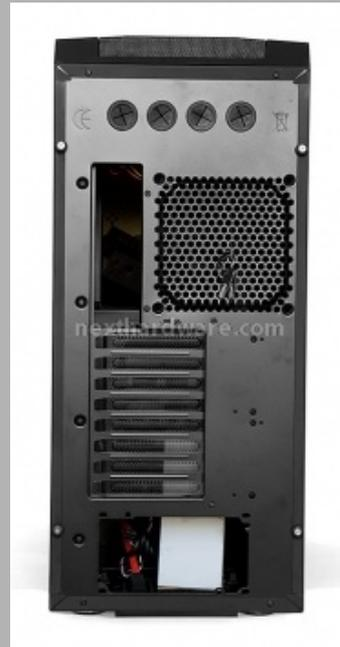
La parte posteriore è interamente verniciata in nero, in perfetta sintonia con il resto del case. In alto sono presenti ben quattro fori, dotati di guarnizione, che vengono in aiuto a chi volesse montare un impianto di raffreddamento a liquido con componenti esterne.
