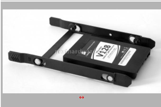
Il montaggio degli HD da 3,5â€ è totalmente tool free, il disco va inserito nel cassetto facendo incastrare i 4 perni negli appositi fori del disco. I 4 fori presenti nel cassetto permettono di installare anche dischi da 2,5â€ ma, in questo caso, bisogna mettere mano al cacciavite. Una volta fissato il disco, il cassetto va inserito nella guida del cestello e spinto fino in fondo, in modo da azionare il meccanismo di blocco.
