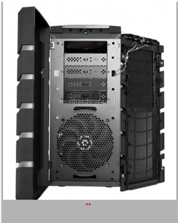
Il pannello frontale è interamente rimovibile tirando la parte bassa verso l'esterno con uno sforzo moderato. Una volta rimosso, si potrà accedere ai vani per l'installazione delle periferiche da 5,25â€ o effettuare la rimozione del filtro anti polvere, posto a protezione della ventola, per le operazioni di pulizia. Tutti i frontalini dei bay da 5,25â€ sono protetti da filtri, facilmente rimovibili all'occorrenza, per la pulizia o sostituzione.
