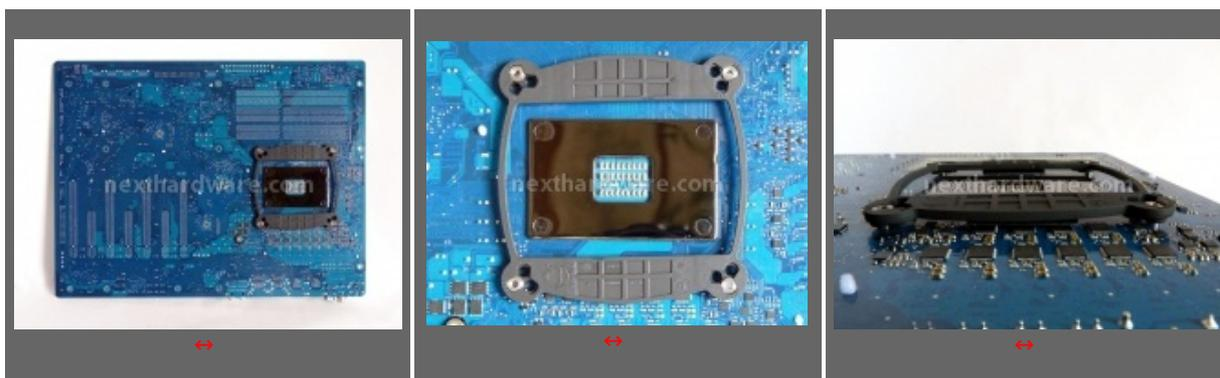
Per prima cosa è necessario posizionare il backplate, operazione molto semplice, basta usare le due strisce di biadesivo per fissare la staffa alla mainboard.
