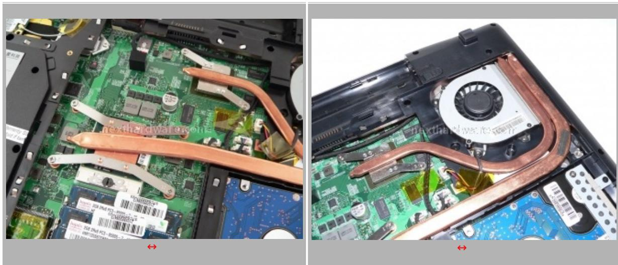
Il sistema di raffreddamento è unificato sia per la CPU che per la GPU e consiste in un unico radiatore collegato ai due chip con due grosse heatpipes piatte. L'unica ventola di raffreddamento risulta avvertibile durante la normale operatività e il calore prodotto è talvolta intenso; per chi è abituato a tenere il portatile sulle gambe non ci sono comunque problemi dal momento che l'espulsione dell'aria calda laterale avviene tramite la griglia laterale.
