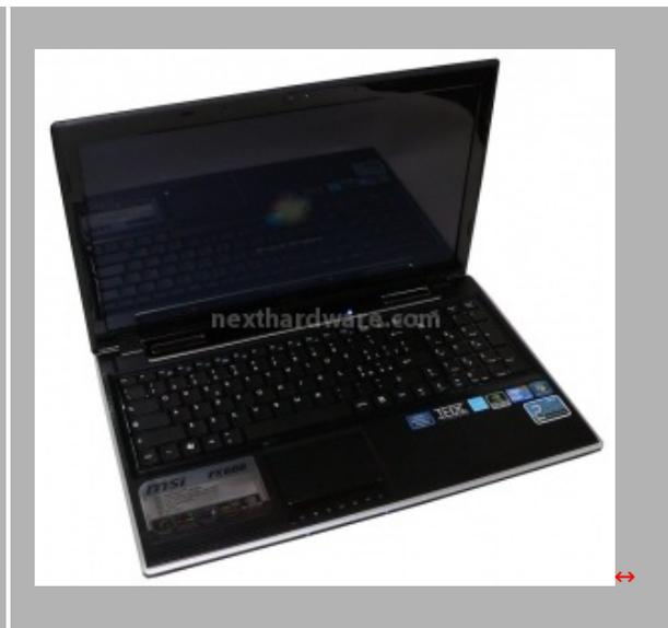
Non sono presenti fermi meccanici per la chiusura del monitor, le cerniere sono sufficientemente rigide per garantire un corretto posizionamento dello schermo durante l'uso ed il trasporto. Nella cornice superiore è presente una webcam con risoluzione HD, un led ne indica l'attivazione quando è in uso.
