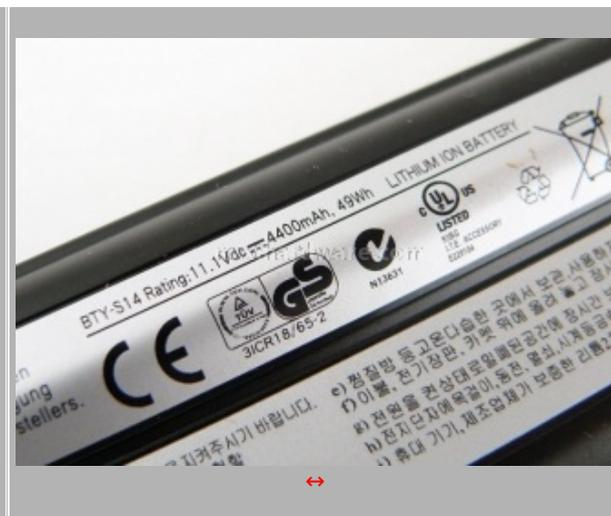
La batteria agli Ioni di Litio è da 4400 mAh, non particolarmente potente per l'HW in dotazione, l'autonomia sarà quindi negativamente influenzata da questo componente.
