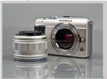
Micro4/3: lo standard prevede che la distanza tra obiettivo e sensore sia ridottissima. Nelle operazioni di sostituzione dell'ottica infatti è bene prestare un minimo di attenzione in più al sensore che è completamente esposto.
