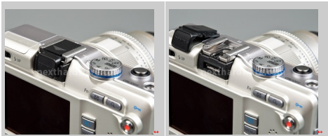
La soluzione adottata sulla E-PL1 per montare il viewfinder elettronico VF2 è pensata per contenere al massimo gli ingombri al di sotto del mirino standard hot shoe per l'unità flash esterna FL-36 si trova infatti una porta attraverso la quale è possibile connettere l'unità VF.
