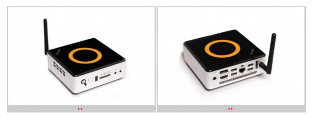
La serie ZOTAC↔® ZBOX nano **VD01** offre un' ampia possibilità di espansione grazie allo spazio per un hard disk SATA da 2.5â€~ â€~ ed un modulo DDR3 SO-DIMM, ↔ mentre i modelli ZBOX nano **VD01 Plus** includono un hard disk SATA da 320GB e 2GB di memoria DDR3.
