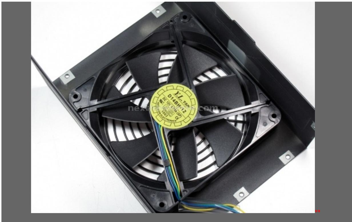
Particolare della ventola installata nel top del cabinet, la particolare disposizione dei dissipatori rende possibile l'utilizzo della ventola senza deflettori.
