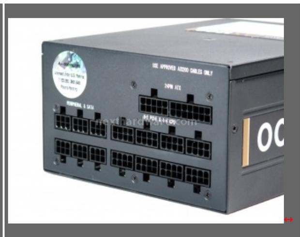
Pannello delle connessioni modulari: come per tutti i single rail non ci sono particolari indicazioni per la distribuzione dei carichi tra le varie linee; di sicuro effetto invece, vedere la grande quantità di connessioni a disposizione.
