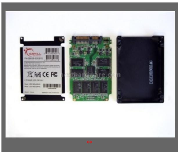
L'insieme degli elementi che compongono la struttura dell'SSD, da destra: Il coperchio superiore, il PCB con l'elettronica di controllo, il guscio inferiore di contenimento.
