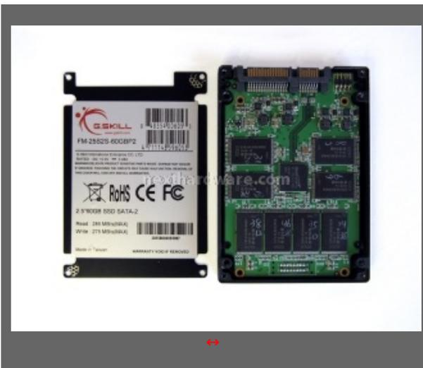
Dopo aver rimosso le 4 viti che assicurano il fondo dell'SSD alla struttura e dopo aver tagliato i due sigilli di garanzia, abbiamo accesso al PCB. Quest'ultimo è a sua volta fissato alla parte superiore dell'SSD tramite altre 4 viti.
