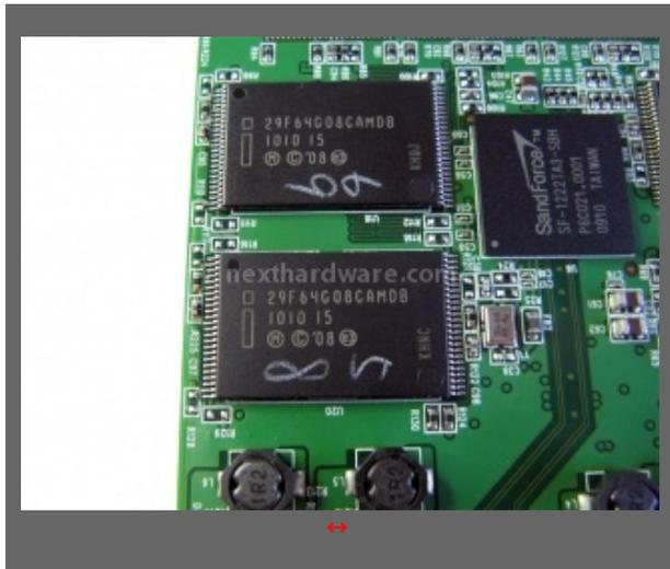
I chip NAND 2Bit Multi Level Cell di seconda generazione sono prodotti da [IM Flash technologies](http://www.imftech.com/) (<http://www.imftech.com/>) con tecnologia 34nm e una densità pari a 8GByte per chip con specifica ONFI 2.0.
