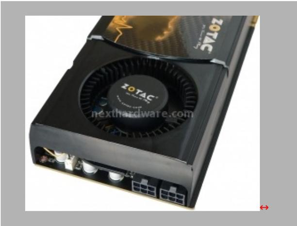
A dispetto delle ridotte dimensioni, la scheda necessita di ben due connessioni PCIEX di alimentazione a 6 pin. NVIDIA dichiara un TDP (Thermal design power) di 160W per il modello da 1 GB e di 150W per il modello da 768 MB di memoria. (Con il TDP NVIDIA indica il massimo consumo registrato nell'uso di applicazioni reali)
