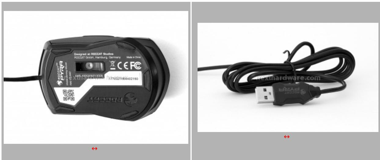
Nella foto di sinistra è visibile il sensore ottico da 1600 DPI con led Blu e i cinque minuscoli ma efficaci padsurfer realizzati in teflon. Il cavo USB è lungo circa 150 cm ed è dotato di un gradevole connettore USB che non prevede però nessuna placcatura in oro.
