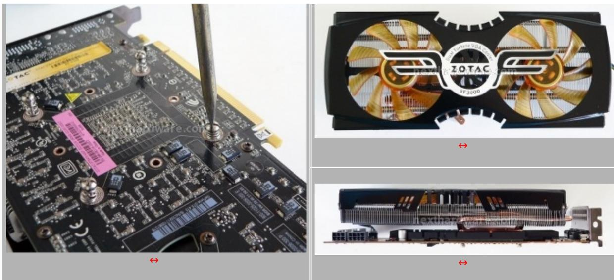
Le due ventole sono gestite attraverso un circuito di termocontrollo con connettore a 4 pin, soluzione originariamente introdotta da Intel per il raffreddamento delle CPU ed oggi entrata di uso comune su tutte le schede video di fascia alta. La particolare disposizione delle ventole non garantisce solo un raffreddamento ottimale della GPU, ma abbassa le temperature di tutto il PCB, allungando la vita dei componenti e generando un generoso flusso d'aria all'interno del case.
