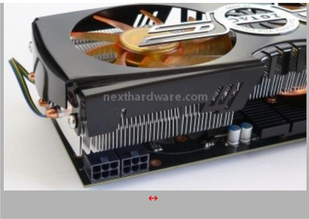
Il sistema di raffreddamento è composto di due parti distinte, uno dedicato al raffreddamento delle memorie e degli altri integrati presenti sul PCB e l'altro dedicato alla sola GPU. Il dissipatore è di produzione Zalman, nello specifico il modello VF3000 caratterizzato da due ventole 80x80 mm e due generosi radiatori in alluminio collegati alla GPU con heatpipes di generose dimensioni.
