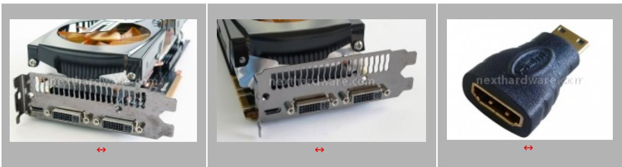
Il circuito di alimentazione delle due schede differisce sia per complessità che per il carico di corrente che è in grado di gestire; per il loro corretto funzionamento le schede richiedono due cavi di alimentazione PCI-E rispettivamente da 6 pin per la GTX 470 e 6 pin + 8 pin per la GTX 480. Al fine di garantire la miglior stabilità operativa, tutti i condensatori installati sono di tipo "solido" di elevata qualità .
