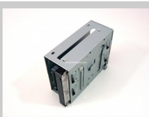
Dettaglio - Slot scorrevole per hard disk
