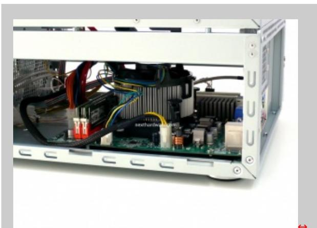
Assemblaggio - Dettaglio dissipatore e ram
