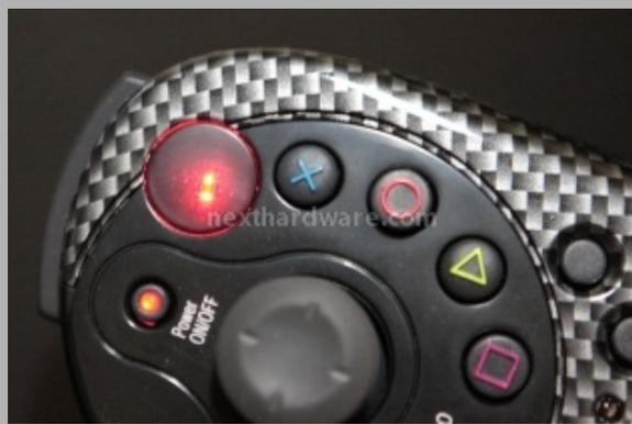
Nell'immagine a sinistra, possiamo notare il sensore di movimento. Il controller, in questo caso, si presenta inclinato verso sinistra. In posizione di riposo, è acceso il solo led centrale e, quando si inizia a ruotare il Chuck nello spazio, si attiva il secondo led corrispondente alla direzione.
