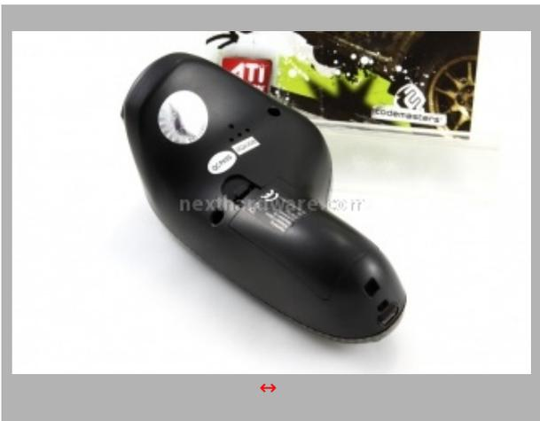
La vista laterale ci mostra la presenza, anche per Evo Chuck, di un pratico interruttore di spegnimento. In questo modo, si risparmiano le batterie quando il prodotto non è utilizzato. Nella parte inferiore, anche in questo caso, è ricavato il vano degli accumulatori.
