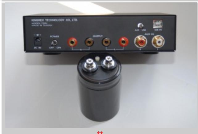
Passando alla parte posteriore, troviamo tutte le connessioni dell'amplicatore, la presa per l'alimentazione e, infine, quello che lo rende diverso dagli altri amplificatori: la presa USB che permette di utilizzare il T20U come DAC connesso ad un PC o portatile.
