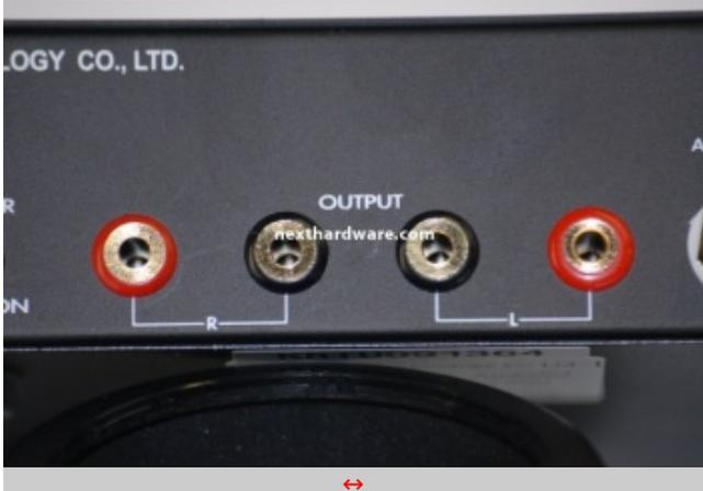
Per la connessione dell'amplicatore ai nostri diffusori, sono state utilizzate delle connessioni che possono ospitare dei plug cosiddetti a banana da 3.5mm, sono placcate in oro e complete di anellino isolante con il colore del polo da connettere.
