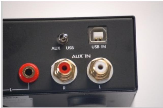
Particolare della connessione USB/RCA, selezionabile mediante l'apposito switch, che ci dà così la possibilità di utilizzare due sorgenti diverse come, per esempio, un CDP e un PC.
