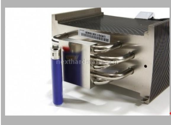
Molto ben realizzata la base, anche se non vediamo segni di saldatura delle heat pipes né alla base stessa, né alle alette, come sarebbe opportuno per un dissipatore appartenente alla fascia di prezzo di Danamics LMX Superleggera.
