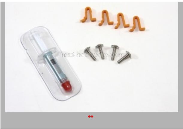
In dotazione troviamo inoltre, imbustati separatamente, i vari supporti di montaggio relativi alle più diffuse piattaforme presenti sul mercato: Intel 1156, 1366 ed AMD AM2/AM3. E' presente anche un tubetto di pasta siliconica e 4 fermi in plastica deputati al bloccaggio delle ventole nelle sedi preposte.
