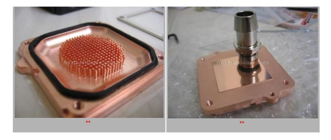
La base è in rame elettrolitico. La struttura è basata su una struttura circolare di micropin come il "fratello†per cpu. La superificie a contatto con il core è leggermente rialzata per evitare che eventuali cornici intorno alla gpu vadano a disturbarne il montaggio. La lappatura della base è ottima.
