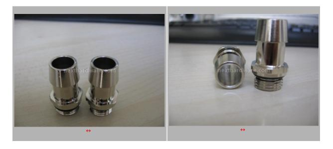
I raccordi in dotazione sono cromati per tubi da 1/2â€; hanno filettatura da 1/4â€G e integrano uno svaso per l'oring di tenuta in modo da garantire la perfetta tenuta anche in caso di un eccessivo serraggio.
