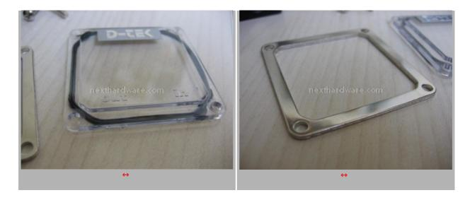
Il top è composto da due parti: una un pleyglass e una in acciaio cromato che va a sovrapporsi all'altra. E' presente un' oring di tenuta che andrà ad alloggiarsi poi nello svaso nella camera di mezzo.
