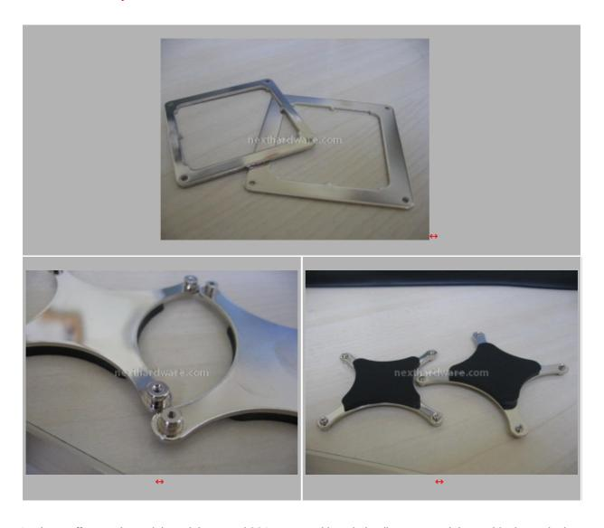
Le due staffe sono in acciaio stainless steel 304; vanno ad inserirsi nella struttura del waterblock tramite le scanalature laterali . In abbinamento alle staffe ci sono due backplate (anch'essi in acciaio cromato) che presentano un pad in materiale plastico dal lato che andrà a contatto con il pcb.
