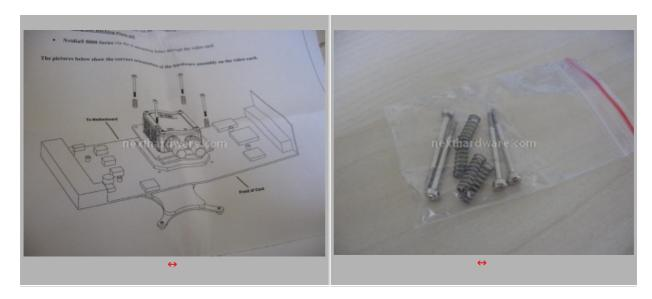
Su un piccolo foglio di carta sono riportate in maniera dettagliata le istruzioni di montaggio del FuZion Gfx . Il serraggio avviene con delle molle che sono compresse da quattro brugole che vanno a fare pressione sulla staffa.
