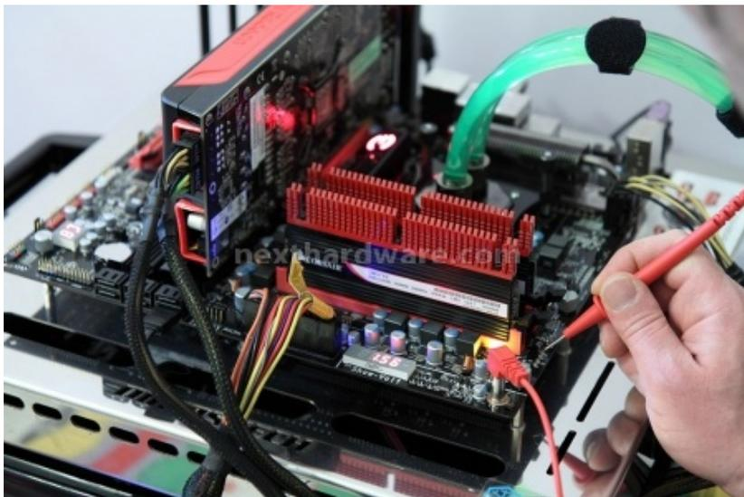
Per questa prova abbiamo cercato di spingere il sistema al massimo utilizzando dei voltaggi compatibili con il sistema di raffreddamento utilizzato, il più alto moltiplicatore della CPU disponibile, il divisore di memoria più appropriato e timings molto aggressivi. Il QPI link è stato impostato a 5.3 GT/sec, un valore che ci ha permesso di avere il massimo delle prestazioni con un VTT non esageratamente alto.
