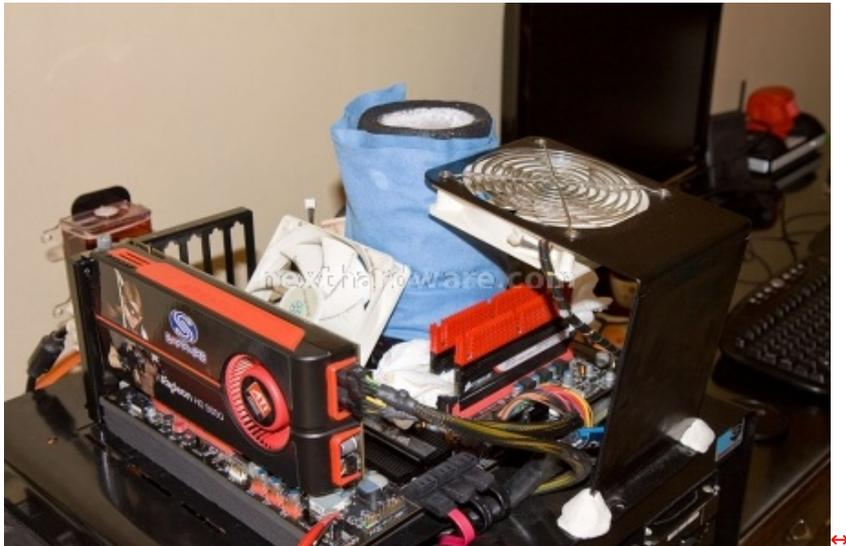
Per questa recensione abbiamo per la prima volta introdotto, data la particolarità della mainboard, anche alcuni test svolti utilizzando un raffreddamento estremo per la cpu, nella fattispecie un evaporatore in rame raffreddato con azoto liquido.
