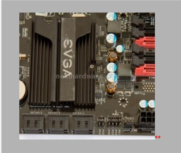
In bella mostra i 5 Slot PCIe rossi pronti ad ospitare un bel numero di VGA, lo slot nero è invece uno slot PCIe x4 adatto per altri scopi. Dei cinque slot PCIe rossi, il primo, il secondo ed il quarto sono x16 se usati singolarmente, il terzo ed il sesto sono invece x8. In configurazione multi vga le combinazioni realizzabili sono:
