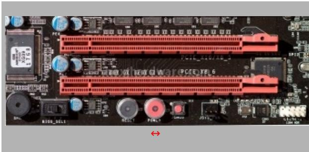
La dotazione di pulsanti onboard prevede i pulsanti di Power ON, il Reset, il pulsantino di CLRmos, ed un selettore che permette di selezionare uno dei due bios on-board.
