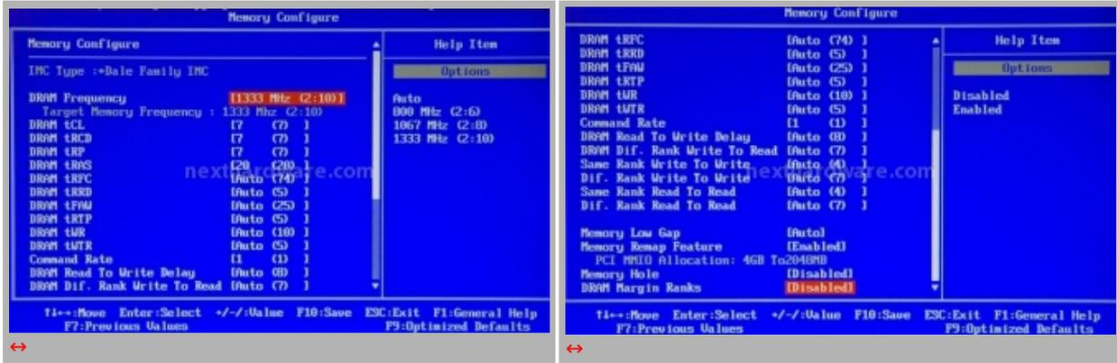
Nel menù "Memory Configure" è possibile impostare i divisori delle memorie, i timings principali ed i vari subtimings; il BIOS comunque, riporta sempre il valore corrente, per guidare l'utente nella scelta delle giuste impostazioni, e la scheda supporta correttamente i profili X.M.P. per la configurazione automatica dei timings delle memorie; discutibile la scelta di EVGA di non offrire la configurazione separata per i due canali.
