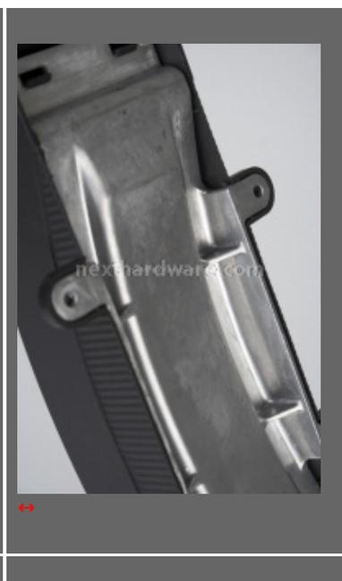
Il piedistallo di sostegno che costituisce il sistema ArcSwing 2 è di robusta fattura e internamente accoglie una slitta di metallo, fusa in un unico pezzo, che scorre e viene automaticamente bloccata grazie ad un congegno a frizione posto al di sotto di essa.
