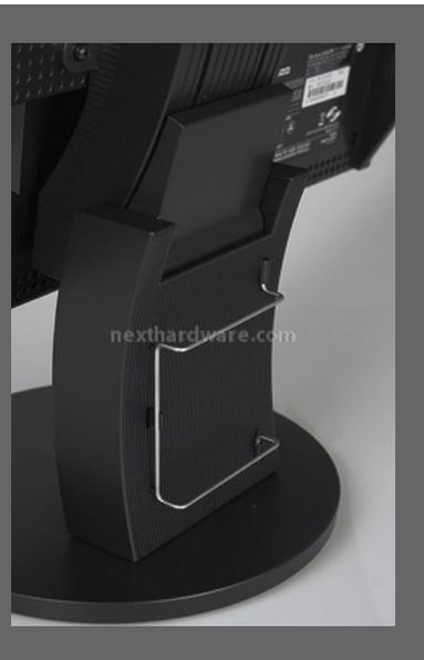
La vista posteriore della colonna del piedistallo cela un semplice quanto efficace sistema a clip in acciaio pensato per disporre in maniera più ordinata i cavi di alimentazione e video senza perderli di vista mascherandoli magari con coperchi in plastica, spesso difficili da rimontare in posizione corretta vista la pressione da esercitare sui corposi fili di connessione.
