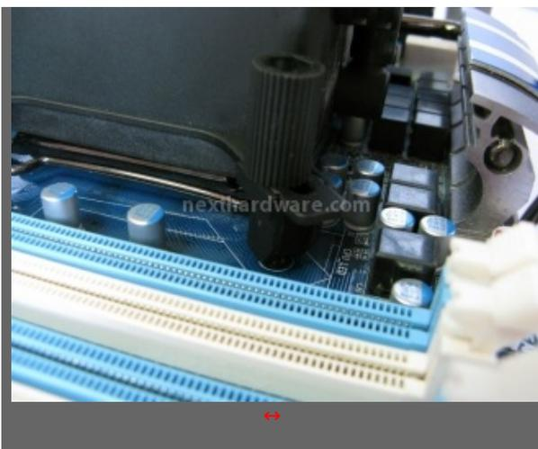
Immagini della piastra con le viti di serraggio, le stesse possiedono un fine corsa, per cui è quasi impossibile rovinare la base della piastra anche stringendo molto. La parte superiore della vite è dotata di un taglio a croce per facilitare le operazioni di serraggio.
