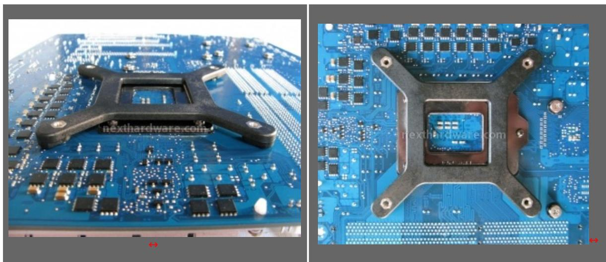
Per prima cosa è necessario posizionare il backplate, operazione molto semplice, basta togliere le due strisce di biadesivo per fissare la staffa al telaio.
