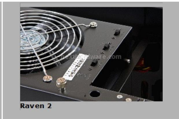
Un particolare del blocco **ventola di estrazione/switch di regolazione ventole di immissione** , comune ad entrambi i case.
