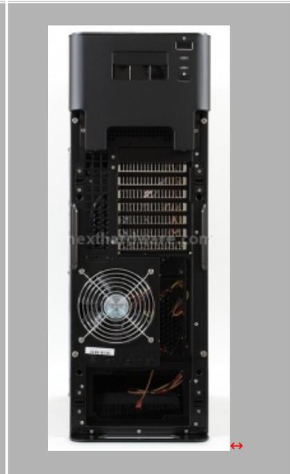
La rimozione del pannello superiore, per accedere alle varie connessioni, è piuttosto semplice. E' sufficiente tirare il pannello verso l'alto come mostrato nelle immagini. Lo stesso infatti, è fissato a pressione sulle 4 viti che fungono da blocco per i pannelli laterali. Dal basso verso l'alto, notiamo quindi: il vano dell'alimentatore, la sede per l'I/O shield, l'unica ventola di estrazione e le aperture verso l'esterno relative agli slot dedicati alle schede di espansione.
