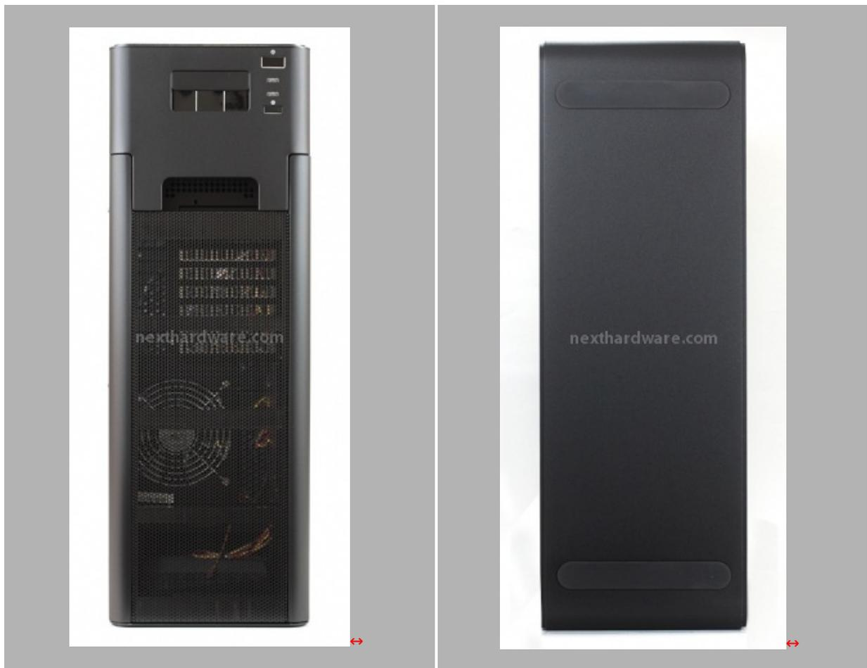
La parte superiore presenta un cover asportabile per permettere l'accesso ai collegamenti delle periferiche esterne. Lo stesso è dotato di una mesh metallica per il passaggio dell'aria espulsa dalla ventola da 120mm presente sul top. Frontalmente sono posti i pulsanti di accensione e reset, provvisti di led di stato, ed uno sportellino a scorrimento. La parte inferiore è dotata di due pad in gomma antiscivolo e antivibrazioni.
