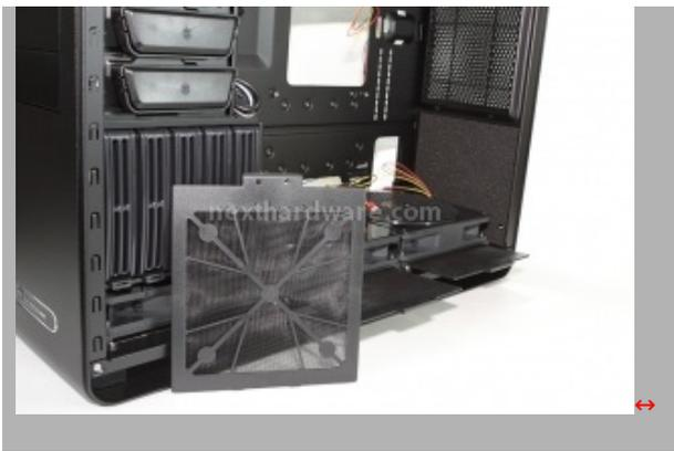
Come in Raven 2, sono 3 le ventole da ben 180mm presenti all'interno di Fortress 2. Le unità sono disposte in immissione e provviste di filtri anti polvere asportabili. Notiamo nella parte posteriore, al di sotto della griglia dell'alimentatore, un pannello di materiale fono assorbente. Notevolmente utili le varie feritoie e "aperture", ricavati per stampo sulla lamiera del supporto scheda madre e dedicati al "cable management".
