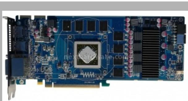
Il PCB della TOXIC è stato pesantemente rivisitato da Sapphire. La sezione di alimentazione è caratterizzata da 4 fasi e sono impiegati quasi esclusivamente condensatori allo stato solido. Sono presenti solo 8 moduli di memoria GDDR5, per un totale di 1 GB di frame buffer. La scheda utilizza l'interfaccia di connessione PCI-E 2.0 per il collegamento al sistema. La GPU integrata è dotata di 1440 unità di elaborazione e la frequenza impostata di fabbrica è pari a 765 Mhz.
