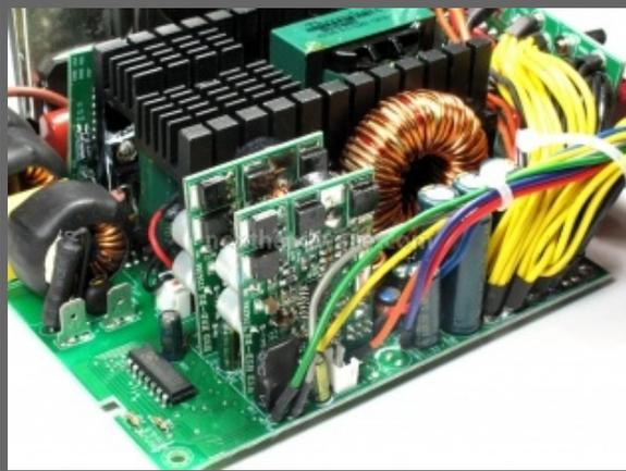
In primo piano i due trasformatori DC-DC destinati ai rails +3,3 e +5,0 volt.
