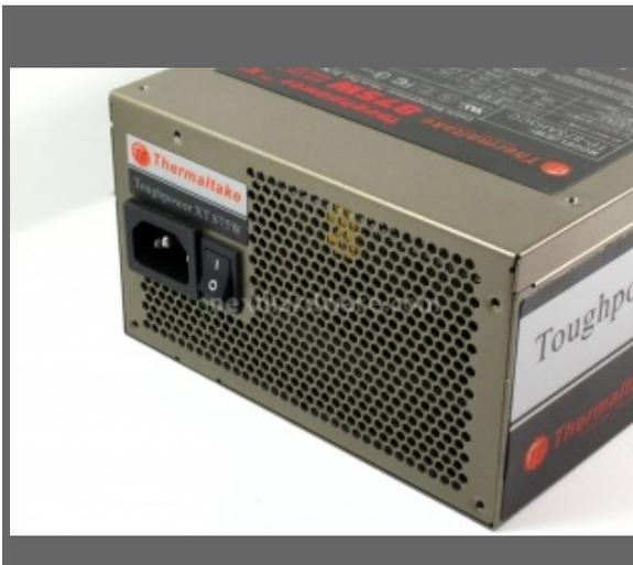
Buono il lato posteriore che lascia il massimo dello spazio al deflusso dell'aria calda in uscita. Eliminato l'inutile selettore che permetteva di scegliere le modalità di funzionamento del sistema **FanDelayCool**. Questo sistema permette alla ventola di rimanere in funzione per un periodo di circa 15-30 secondi dopo lo spegnimento.
