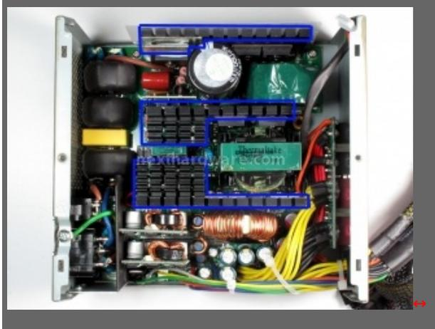
In linea con le attuali tendenze, l'area dissipante dell'interno alimentatore è molto ridotta, tuttavia rispetto al gemello di Corsair, il ToughPower ha dei dissipatori più elaborati e sicuramente più performanti.
