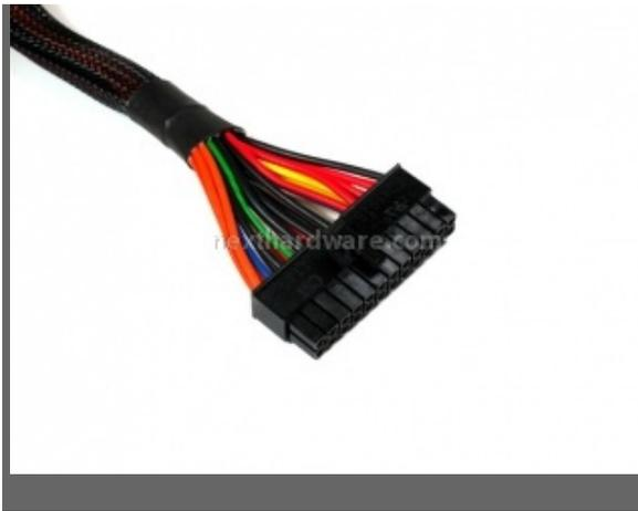
Cavo di alimentazione ATX 24pin
