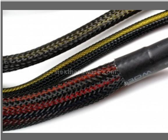
Sleaving di qualità per i cavi saldati e meno curato invece, per le connessioni modulari. Buona però la scelta di mettere delle "ferriti" in corrispondenza delle terminazioni Pci-Express.
