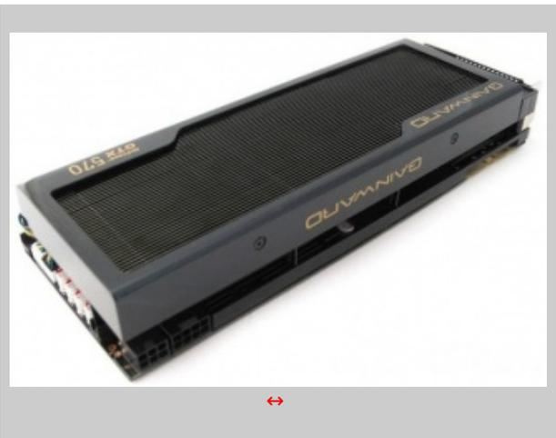
Gainward presenta la GeForce GTX 570 Phantom, scheda video equipaggiata con GPU GF110 overcloccata di fabbrica e con un dispositivo di raffreddamento personalizzato dotato di tre ventole PWM e di sei heatpipes in rame nichelato.
