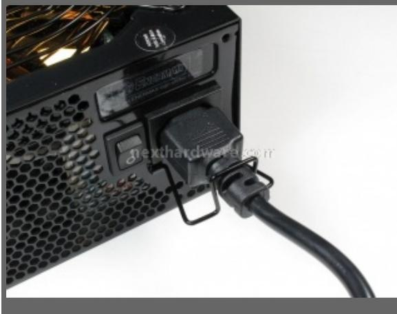
Per la prima volta Enermax introduce il sistema **CableGuard**: una clip metallica che evita l'accidentale disconnessione del cavo di alimentazione.
