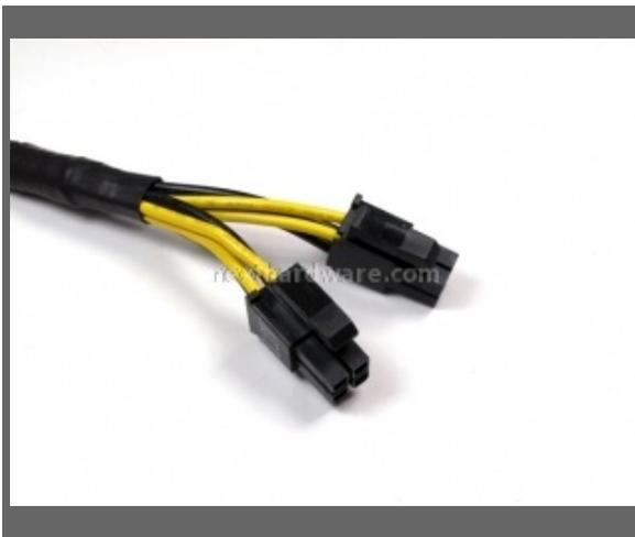
Cavo di alimentazione ATX 12volt 4+4pin
