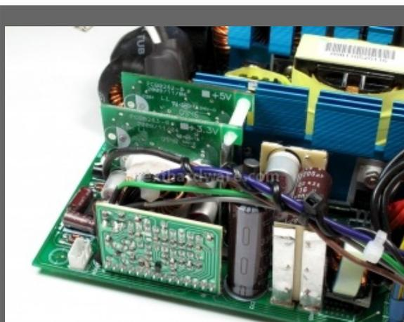
In primo piano i due trasformatori DC-DC destinati ai rails +3,3 e +5,0 volt.
