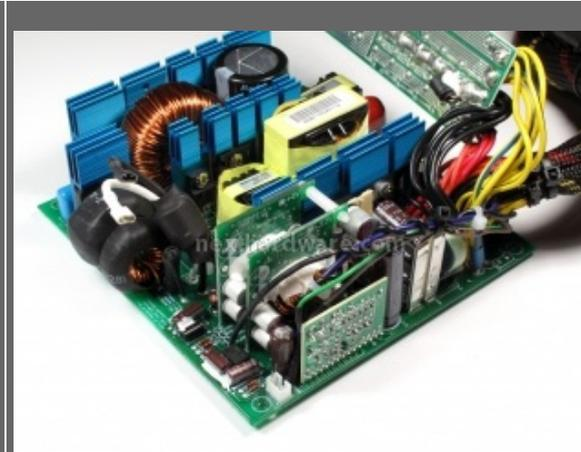
In queste immagini il MODU smontato completamente dal telaio. Possiamo osservare la scheda per i cablaggi modulari e i due trasformatori DC-DC per la linea +3,3 e 5,0 volt.
