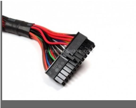
Cavo di alimentazione ATX 24pin
