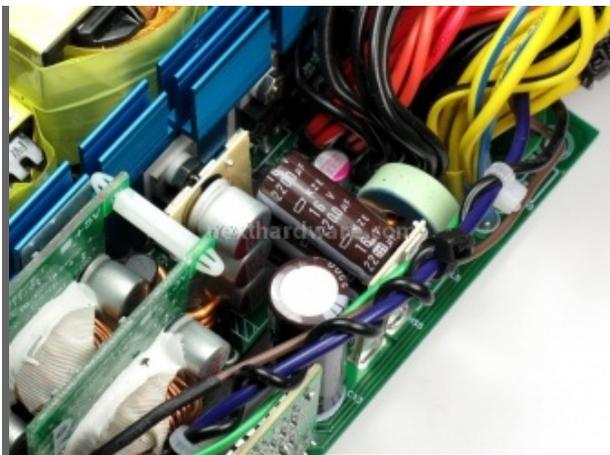
Per i condensatori in uscita troviamo un'altra particolare innovazione, il sistema **Hybrid Capacitor Array**.
