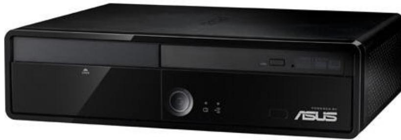
Asus presenta per l'Europa il barebone S1-AT5NM10E, un mediacenter che misura 267 (W) x 68,3 (H) x 196,6 (P) mm, dispone di un processore Atom dual-core D525 da 1,80GHz↔↔ ed una scheda video integrata NVIDIA ION di seconda generazione (GPU GT218 a 40nm↔).
