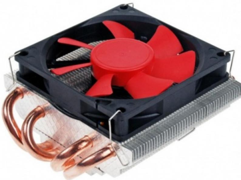
Evercool presenta il suo nuovo dispositivo di raffreddamento per CPU, il dissipatore HPL-815, che monta una ventole da 80 millimetri, con un regime di rotazione impostabile↔ da 1000 a 1400 RPM e con una rumorosità che varia da 12 a 40 dBA.
