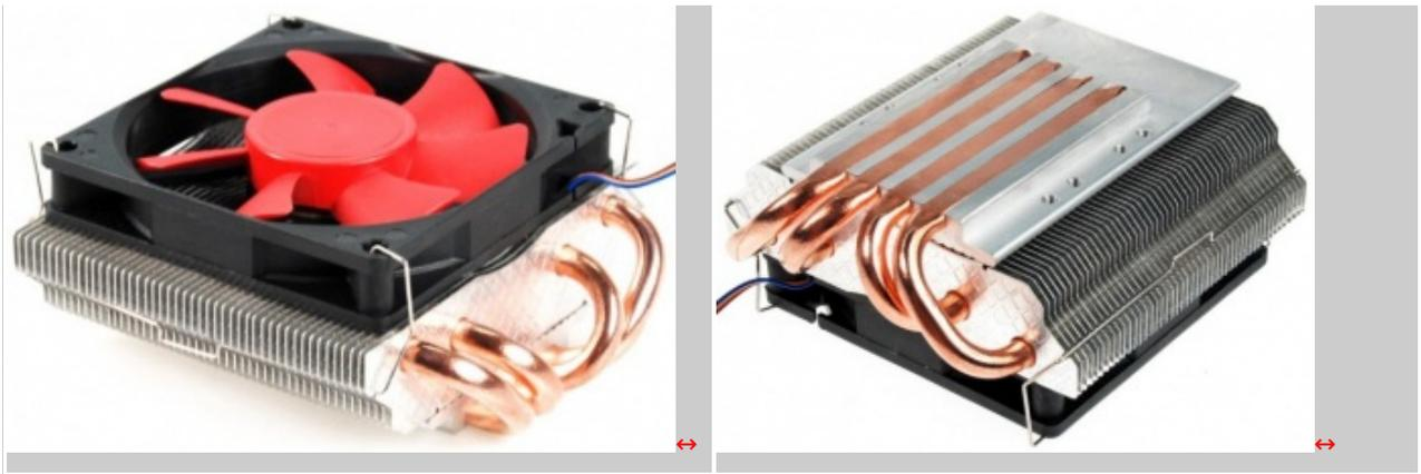
Il prodotto misura 106 (L) x 95 (W) x 45 (H) mm, pesa 320 grammi, dispone di quattro heatpipe da 6 millimetri, una base di rame nichelato, e un corpo dissipante formato da 48 alette in alluminio da 0,5 millimetri di spessore per una migliore dissipazione del calore. Il dissipatore HPL-815 è compatibile con i socket Intel LGA 1366/1156/775 e AMD AM2/AM2+/AM3. Il prezzo del prodotto non è stato ancora reso noto.
