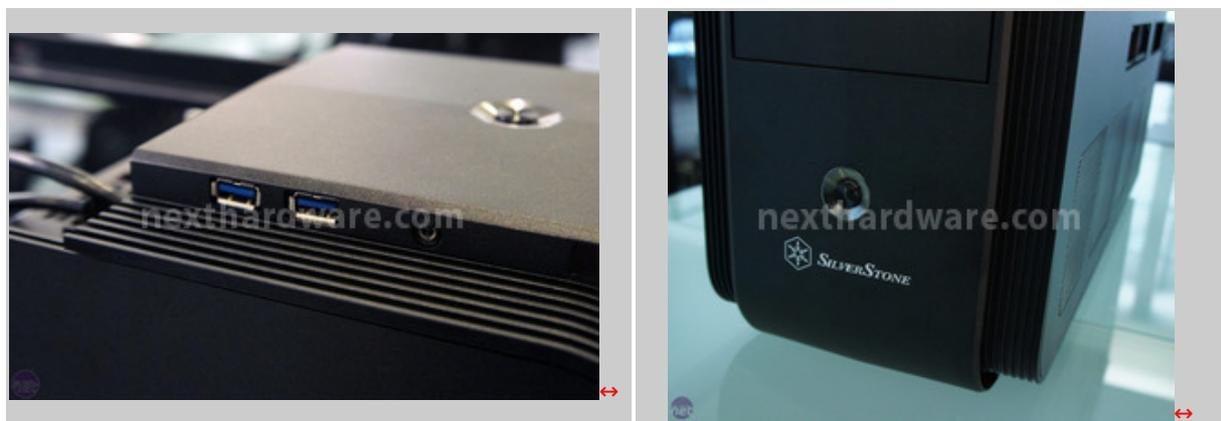
Il case è realizzato interamente in alluminio anodizzato nero, con il telaio monoblocco ad U e le paratie spesse ben 2mm. Presenta 9 bay da 5,25" a vista, design del supporto mainboard ribaltato di 90° ed estraibile per un montaggio rapido e senza problemi, paratia con finestra in plexyglass, ventole Air Penetrator in dotazione, due porte USB 3.0.
