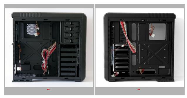
La parte sinistra del case, spogliata della sua paratia, ci mostra l'alloggiamento per la ventola laterale da 80mm dedicata al raffreddamento della zona retro-socket, che risulta molto comodo per montare dissipatori o waterblock dotati di backplate senza dover smontare la mainboard. Il passaggio di tutti i cavi di collegamento da questa zona verso la scheda, è assicurato da quattro aperture di forma ellittica dotate di bordi arrotondati.
