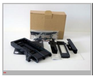
Il bundle comprende un adattatore per il montaggio del lettore floppy con relativa mascherina, la classica viteria, qualche fascetta per raccogliere i cavi durante l'assemblaggio, il manuale utente che illustra le fasi principali per l'assemblaggio, un filtro antipolvere di ricambio, ed un supporto per schede video.
