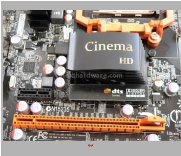
Il voluminoso dissipatore in alluminio con la scritta Cinema HD copre il cuore della scheda, raffreddando il chipset AMD 785G. Le generose dimensioni garantiscono ottime temperature operative perché investito dal flusso d'aria prodotto dalla ventola della CPU.
