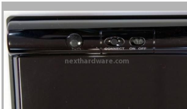
Nella parte sottostante della tastiera troviamo i due tasti deputati all'accensione/spengimento del ricevitore RF e alla connessione con il micro trasmettitore USB collegato al PC.
