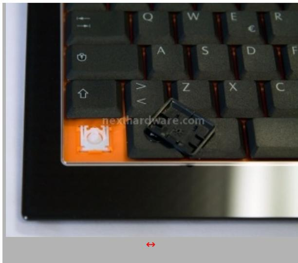
Scissor è il vocabolo inglese che identifica le forbici. In effetti il meccanismo di pressione ricorda il pratico strumento da taglio. I due leveraggi, in bianco, sono collegati ad incastro al tasto. Il tronco del cono centrale in gomma non è altro che la copertura di un'ipotetica molla. Non è difficile immaginare quindi il funzionamento del complesso. La tecnologia in questione è proprietaria e brevettata da ENERMAX.
