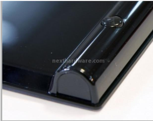
Tutti gli spigoli della Acrylux sono stati smussati con una lavorazione a regola d'arte per offrire il massimo della sicurezza e del comfort durante l'utilizzo. La scocca in resina acrilica con durezza 7H offre una lucentezza ed una resistenza ai graffi senza pari, unico problema saranno le impronte facilmente visibili in un materiale così lucido; ma questo può essere un incentivo a pulire più spesso la tastiera, un'operazione che spesso gli utenti trascurano.
