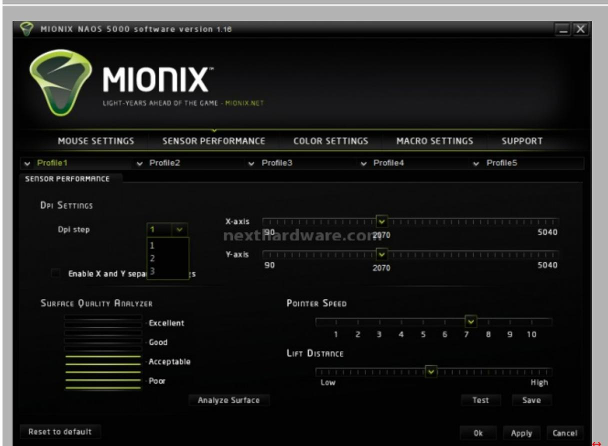
In questa sezione sono presenti le opzioni di regolazione relative al sensore. E' possibile regolare la sensibilità su 3 valori ed indipendentemente per gli assi x ed y. E' presente anche un pratico tool di analisi della superficie di appoggio del mouse.
