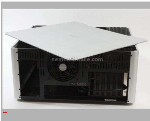
Il pannello superiore del Luxa2 LM300 Touch Pro è interamente in alluminio anodizzato con lavorazione a spazzola della superficie.
