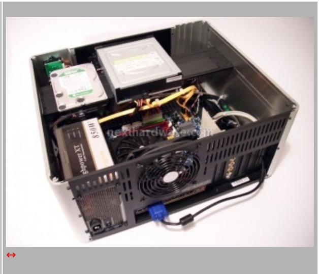
Una volta rimessa nell'apposita sede la piastra di sostegno con i drive montati e fissata con le apposite viti, il nostro lavoro di assemblaggio è terminato. Come si può osservare il cablaggio risulterà praticamente invisibile e non ci darà fastidio durante i lavori di manutenzione all'interno del cabinet.
