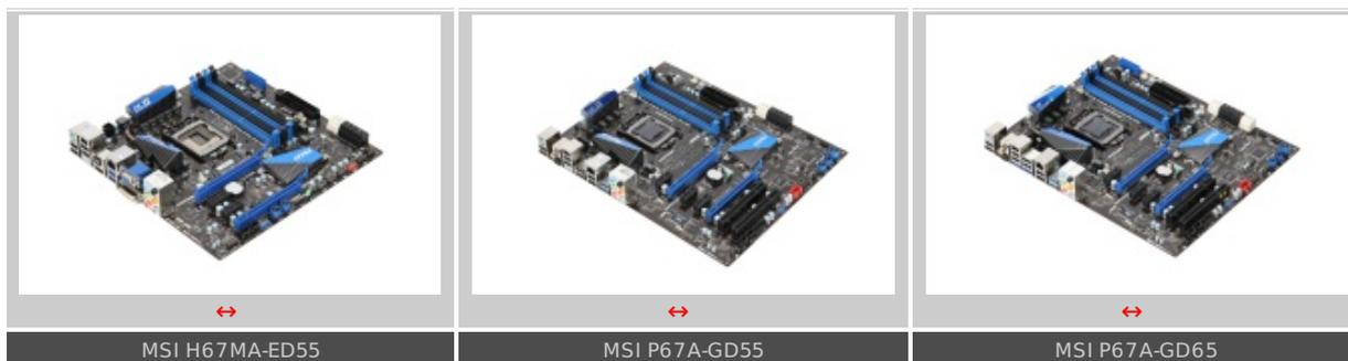
Le tre schede madri MSI saranno lanciate all'inizio del 2011 e sono progettate per processori LGA 1155, supportano 4 moduli di memoria DDR3, e sono dotate di una porta LAN Gigabit Ethernet, porte USB 3.0 e SATA 6Gbps.
